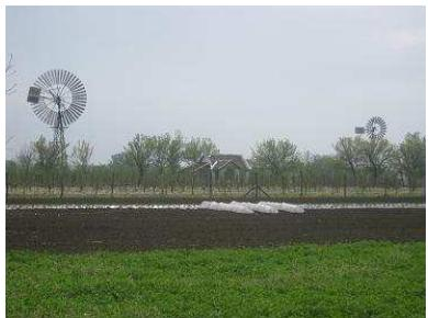
u neposrednoj blizini naselja Deronje. Vlasnik i konstruktor dva vetrogeneratora koja su postavljena na sopstvenom imanju je Savić Branislav. U ovom slučaju, vetrogenerator vetar pretvara u mehaničku energiju koj služi za navodnjavanje po sistemu kap po kap, 4 jutra površine voćnjaka i povrtnjaka.
